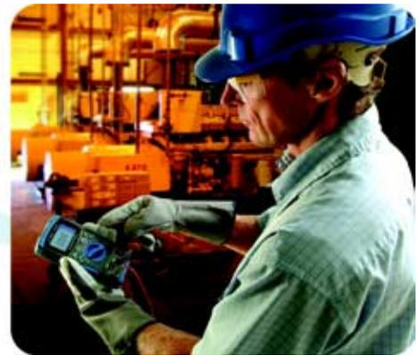
用精确可靠数字万用表作日常维护能保证尽早探测到交流电源中的谐波。检测和确定谐波所造成失真百分比的一种最快方法是测量输入交流电压的谐波比。
